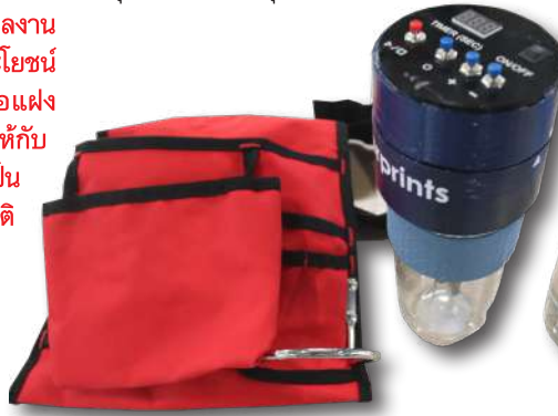
เครื่องตรวจหารอยนิ้วมือแฝงบนปลอกกระสุนแบบพกพา
